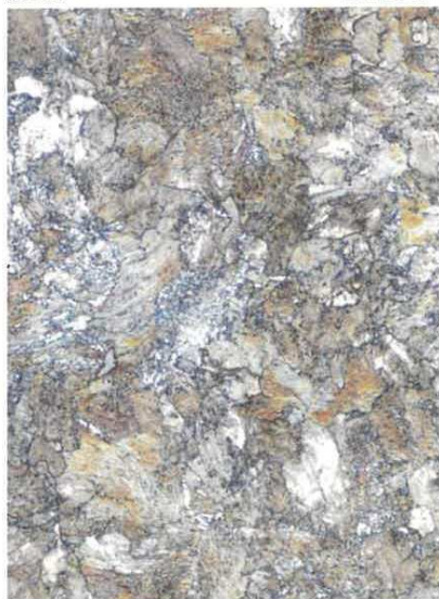
Obr. 8 – Část protokolu zkoušení mikrostruktury vzorku předpínacího lana
